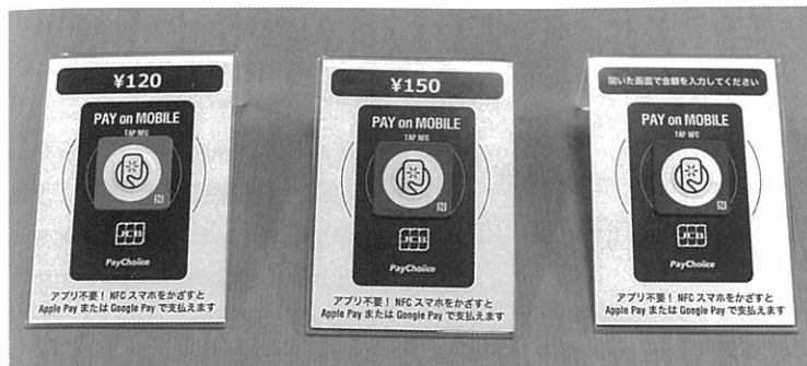
▲決済用NFCタグは、金額固定タイプとユーザー入力タイプがある。前者の金額はタグに書かれた情報とひと付けする形で、サーバ側にて管理されている
